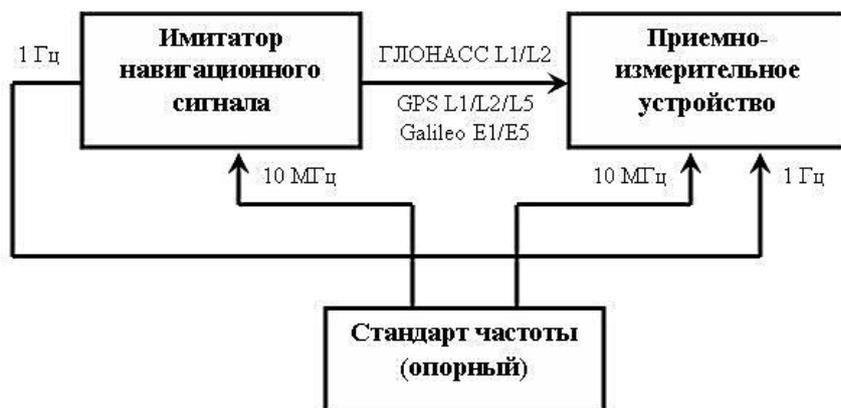
Рис. 1. Схема измерений при реализации непосредственной калибровки
