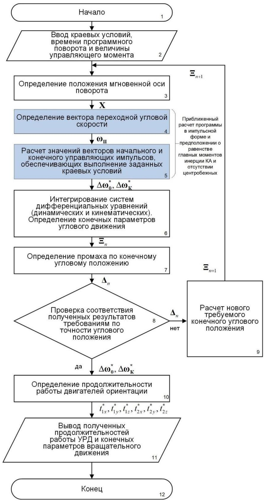
Рис. 6. Применение МПКО для расчета параметров управления пространственной ориентацией
